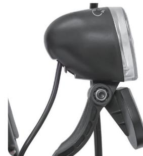
5.2 Ajuster le phare à un angle approprié de la façon suivante : desserrer la vis de réglage avec un tournevis cruciforme, ajuster l'angle d'inclinaison du phare à la meilleure position, puis serrer le boulon.
