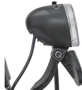
5.2 Ustaw lampkę pod odpowiednim kątem, aby oświetlała drogę przed Tobą. Sposób ustawiania lampki: Poluzuj śrubę regulacyjną za pomocą śrubokręta krzyżakowego, ustaw kąt nachylenia lampki, a następnie dokręć śrubę.
