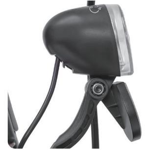
5.2. Stellen Sie den Scheinwerfer wie folgt ein: Lösen Sie die Einstellschraube mit einem Kreuzschlitzschraubendreher, stellen Sie den Neigungswinkel des Scheinwerfers auf die beste Position ein und ziehen Sie die Schraube dann wieder fest.
